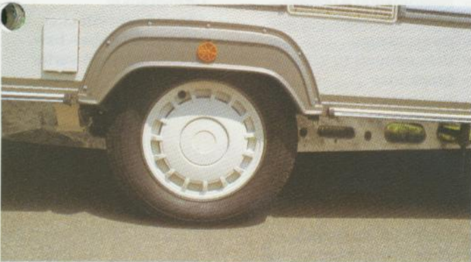
Breitspurfahrwerk mit Einzerradaufhängung.
