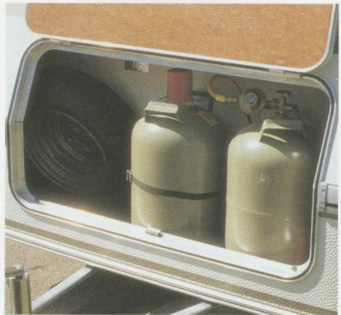
Integrierter Deichselkasten, großräumig mit Platz für 2 x 11 kg Gasflaschen, Reserverad und vielen Utensilien.
