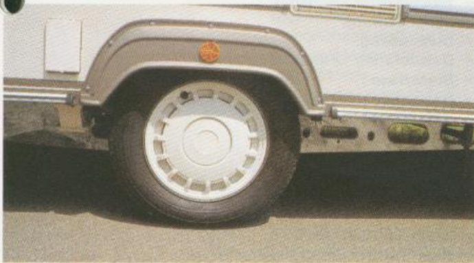
Breitspurfahrwerk mit Einzelradaufhängung.
