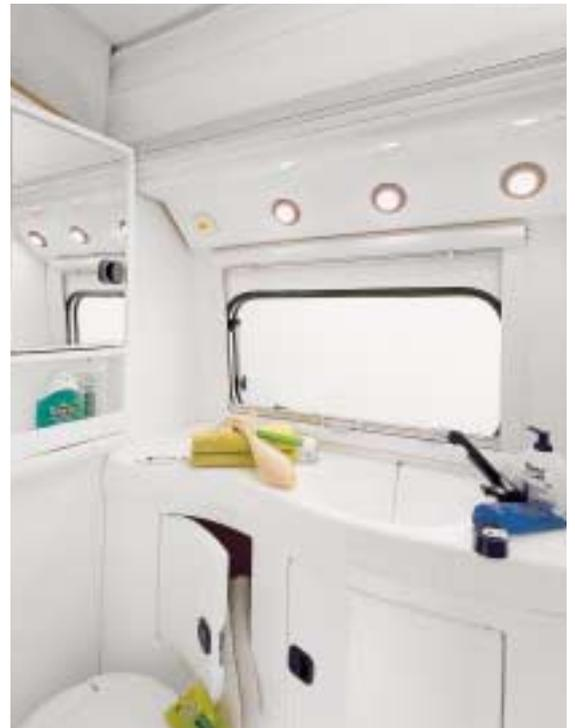
Kalt- und Warmwasserversorgung – serienmäßig bei allen Eriba-Moving- und Eriba-Nova-Modellen – erfolgt durch einen 45-l-Frischwassertank, wobei das gesamte Wasserversorgungssystem über service- und wartungsfreundliche, innenliegende Leitungen verläuft. Hochwertige Keramikdichtungen in den Armaturen sorgen für eine lange Lebensdauer.
